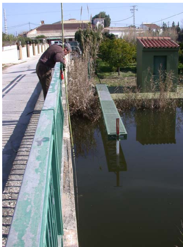
SECCIÓN DE AFORO DIRECTO EN EL RÍO RACONS JUNTO A LA ESTACIÓN FIJA DE LA DPA
